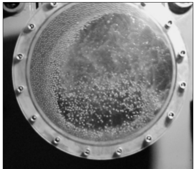
Bild 7: Beanspruchungsmechanismus des Mahlgutes bei der nassen Feinstmahlung in einer Zentrifugalmühle, Mahlkörperfüllungsgrad 30%, Rohrdurchmesser 350 mm, Schwingkreisdurchmesser 150 mm
