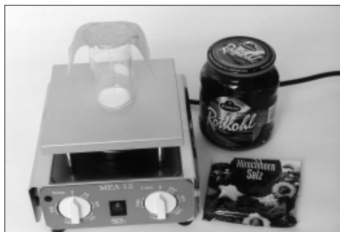
Bild 1: Nachweis von Ammoniak aus der thermischen Zersetzung von Hirschhornsalz mit Hilfe des pH-Indikators Rotkohlsaft auf einem Papierstreifen
