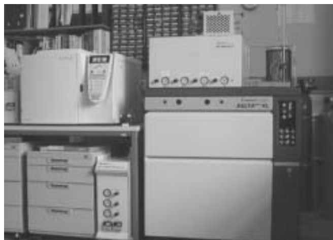
Bild 4: Gaschromatograph mit Massenspektrometer zur Analyse von Isotopenverhältnissen (GC-irMS)
