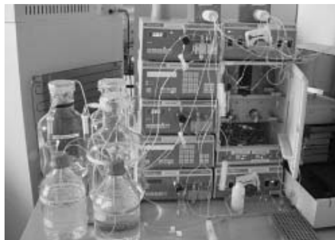
Bild 3: Ionenchromatograph der Firma Metrohm zur simultanen Bestimmung der Anionen und Kationen oder zur simultanen Doppelbestimmung des Broms auf zwei unabhängigen Säulen
