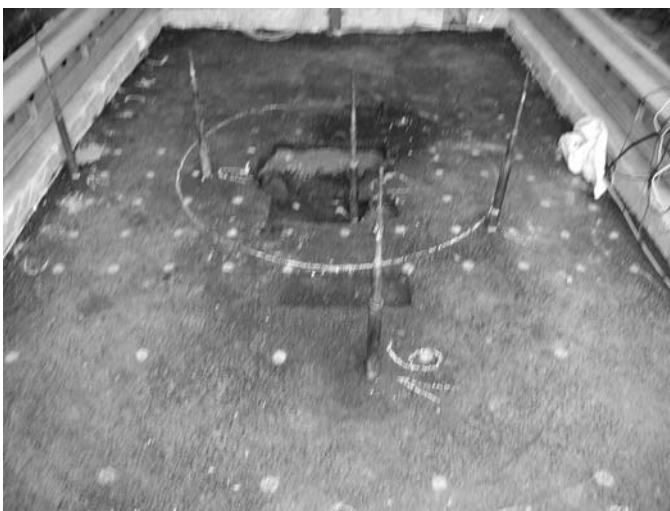
Bild 3a und b: Beispiel kegelförmiger Einbruchbereich und Lastabtragungsbereiche für ausgewählte Geokunststoffe
