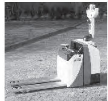
Abbildung 3: Elektro-Geh-Gabelhubwagen mit 2t Nutzlast
