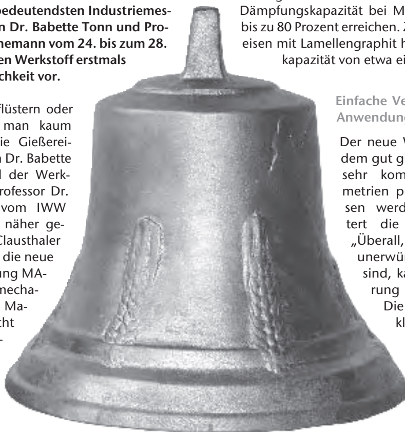
Läutet nur gedämpft: Eine Glocke aus der MAXIDAMP-Gusslegierung
