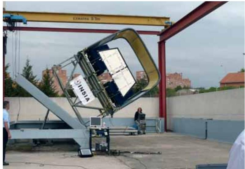
An der Versuchszelle, die in der neuen Sandwichstruktur erstellt worden ist, läuft der Überrolltest.
