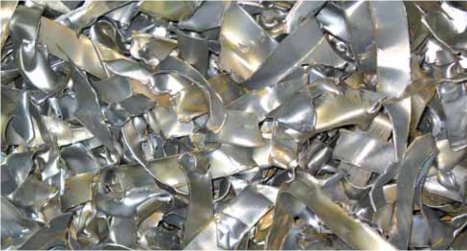
Innerhalb von 10 Minuten wird Stahlschrott in der Clausthaler Anlage vollständig entzinkt.
