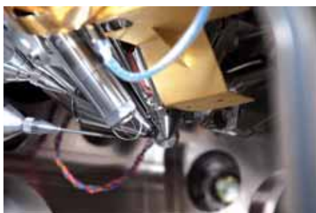
Blick in die geöffnete Probenkammer des Elektronenmikroskops mit seinen diversen Detektoren.
