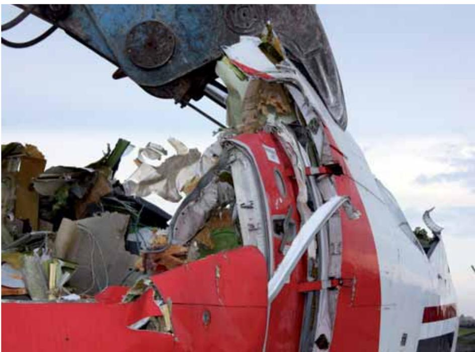
Mit einer mobilen Recyclingeinheit werden die Flugzeuge zerlegt.
