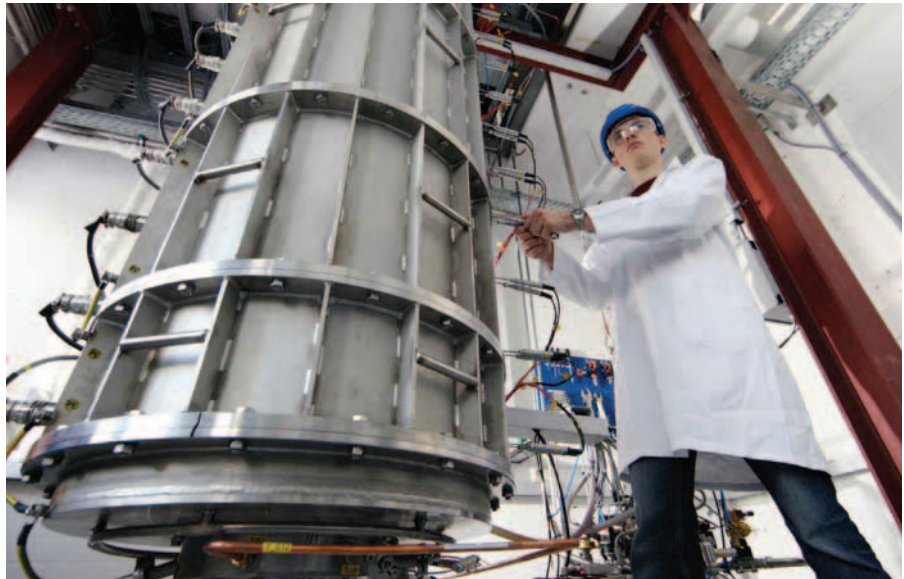
In dem neuen Fallrohrreaktor werden beispielsweise keramische Pulver auf ihr Verhalten in verschiedenen Hochtemperatur-Reaktionen untersucht.
