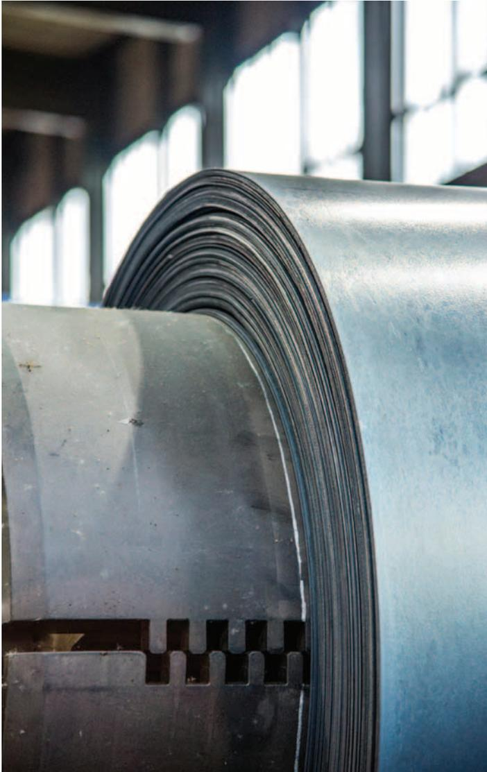
Im Aufbau befindliches Warmbandcoil aus Bandguss.
