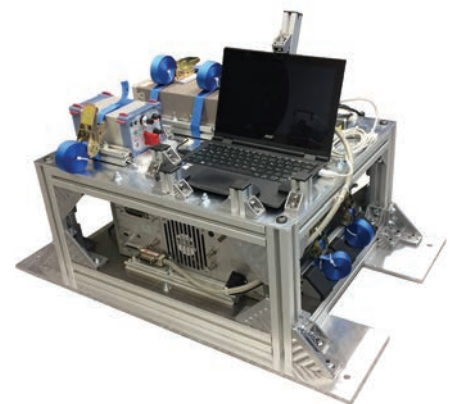
Knudsen-Messaufbau mit allen Geräten zur Ansteuerung der Zelle und zur Erfassung bzw. Auswertung der Daten.
